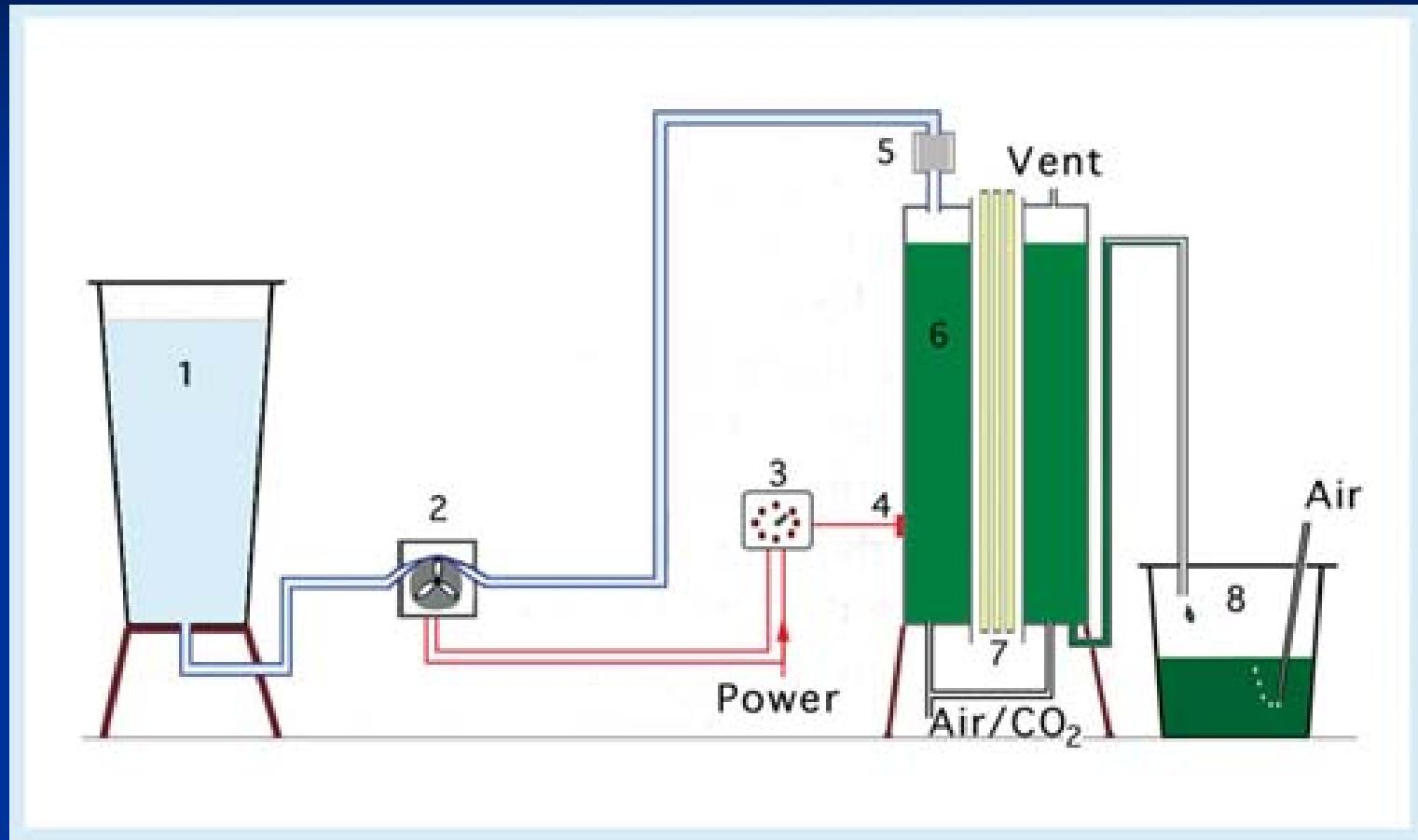
**1**, Dưỡng chất (200 L); **2**, Bơm định lượng; **3**, Bộ cảm biến (50 - 5 000 ohms); **4**, Bộ bắt sáng (ORP 12); **5**, Bộ lọc (0.45 µm); **6**, Cột tăng sinh (80 L); **7**, Đèn huỳnh quang; **8**, Bể chứa tảo (125 L).
